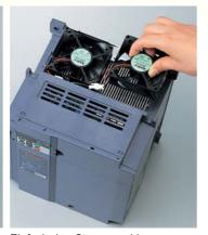
Einfach den Stromanschluss abziehen und den Lüfter austauschen.
